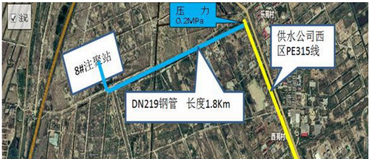
图 2.5-3 8#配注站目前供水管线示意图
